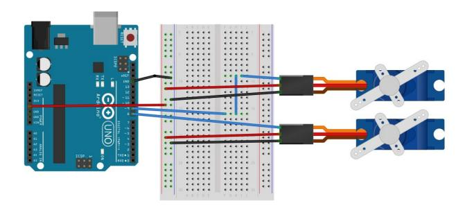
Su funcionamiento será sencillo, simplemente se moverán ambos servos de 0 a 120° y de 120° a 0°. Simulará el movimiento del ojo de un camaleón.
