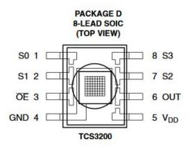
Como podemos observar disponemos las 8 patillas del SOIC, no se corresponden exactamente con la imagen de la izquierda 10 ya que se repiten 2 GND y 2 VCC.
