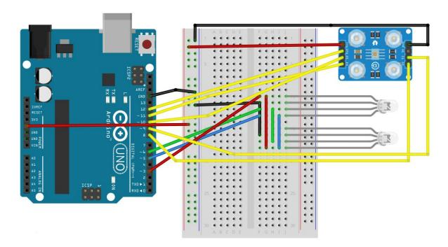
Su funcionamiento será que el camaleón en la parte de abajo tiene el sensor y cuando se ponga encima de un color determinado se iluminará de ese color.
